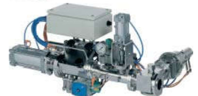
Operatividad del pig y estaciones lanzadoras controladas por ordenador
